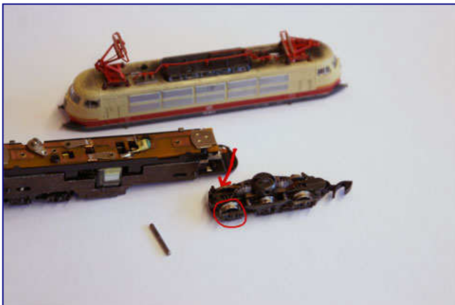
An der teilzerlegten Lok sind einige Modifikationen erkennbar: Auf der hinteren Achse wurde ein Jörgler-Haftreifen aufgezogen (siehe Pfeil; ein weiterer befindet sich auf der gegenüberliegenden Seite an der Innenachse des zweiten Drehgestells). Die Radseitenflächen wurden für eine stimmige Optik schwarz lackiert (siehe Kreis).
