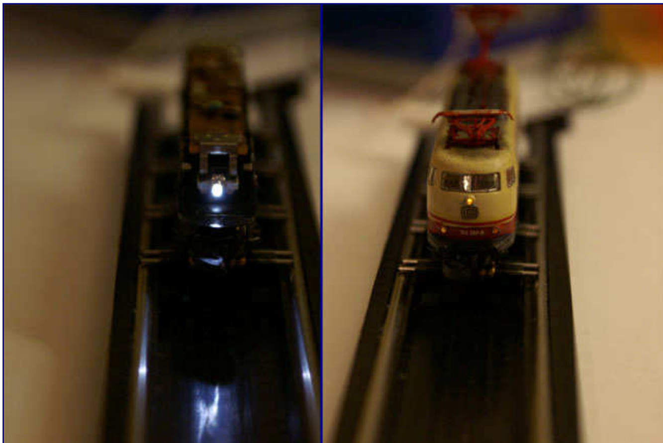
Das Farbspektrum der weißen LED-Bausteine im direkten Vergleich an der hier vorgestellten Lok: Während links die unbehandelte LED ein sehr kaltes und bläulichiges Licht liefert, kommt die Lichttemperatur der abgetönten Leuchtdiode der ursprünglichen Glühlampe sehr nahe. Der Gewinn liegt in der Wartungsfreiheit und besseren Ausleuchtung bereits bei niedriger Fahrspannung.
