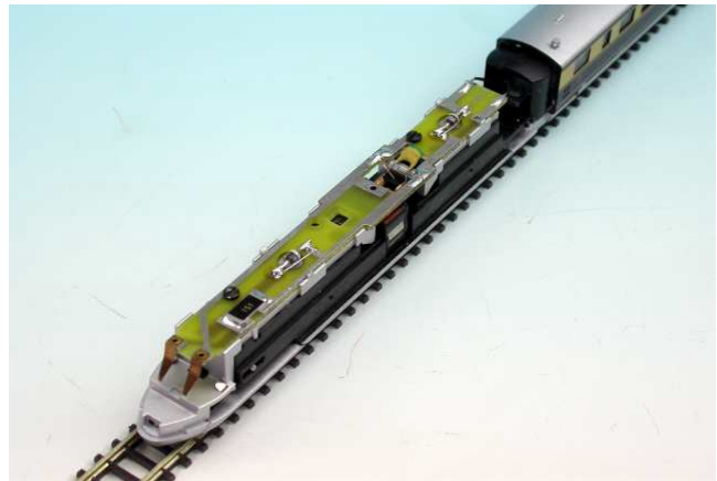
der offene SVT-Triebkopf – zu sehen die überbrückten Dioden
