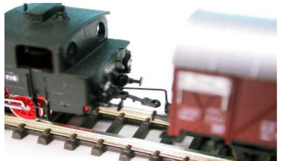
Bild 3: Kuppeln an einem neueren Kupplungshaken
