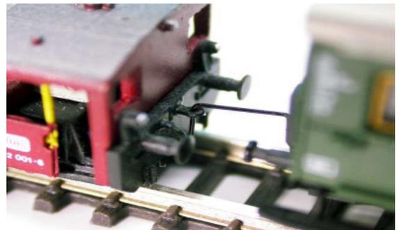
Bild 2: Kuppeln an einer Öse
