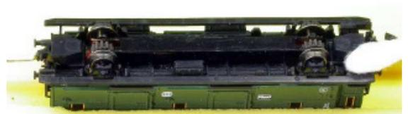
Bild 4: Reinigung der Laufflächen
