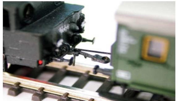
Bild 3: Kuppeln an einem neueren Kupplungshaken
