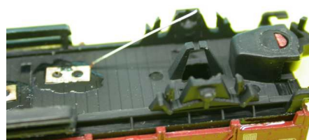
Bild 8: die richtige Stellung des Stromabnehmers ohne Radachse.
