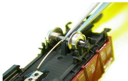
Bild 4: Mit einer feinen Pinzette wird die Achse in die Klammer eingedrückt.
