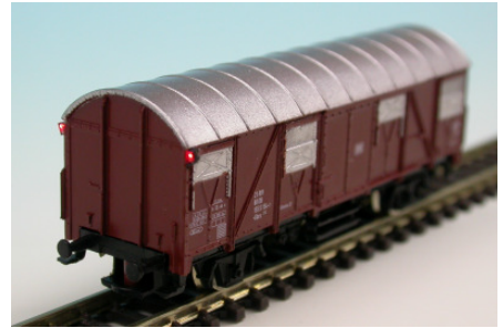
Bild 1: rote Schlussbeleuchtung im gedeckten Güterwaggon
