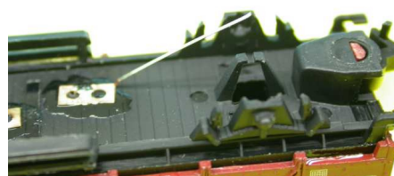
Bild 8: die richtige Stellung des Stromabnehmers ohne Radachse.
