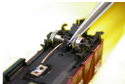
Bild 5: Die Achse ist unter die Klammer gedrückt, die sie festhält.
