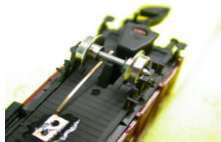
Bild 3: Die Achse liegt zum Einbau bereit auf der Klammer
