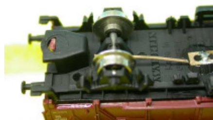
Bild 6: die isolierte Seite des Rades, dem Stromabnehmer abgewandt
