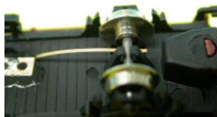
Bild 7: die nicht isolierte Seite – immer dort wo der Stromabnehmer sitzt. Unbedingt beachten!
