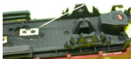
Bild 8: die richtige Stellung des Stromabnehmers ohne Radachse.
