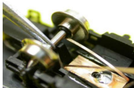
Bild 4: Mit einer feinen Pinzette wird die Achse in die Klammer eingedrückt.
