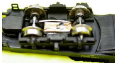
Bild 6: linkes Drehgestell: **beide** Achsen mit der isolierten Seite nach oben
