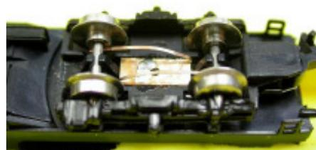
Bild 7: rechtes Drehgestell: **beide** Achsen mit der nicht isolierten Seite nach oben. Unbedingt beachten
