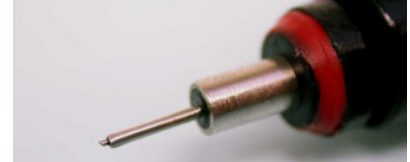
Bild 2: die feine Spitze, hier mit dem Stift, der das Öl nach vorne befördert.
