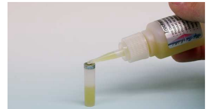
Bild 8: ohne Sauerei, mit der feinen Spitze der Flasche vom 5980 füllt man die kleine Patrone des Micro-Ölgebers auf.
