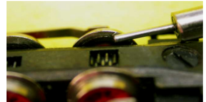
Bild 4: der Micro-Ölgeber im Einsatz an einer BR 89. Man sieht es geht auch bei den Kleinsten
