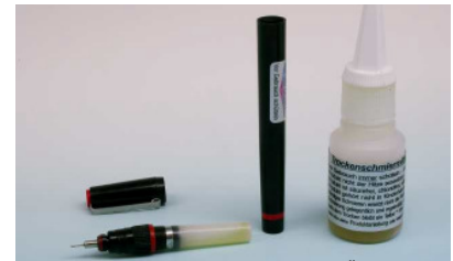
Bild 7: Nachfüllprozedur, der zerlegte Ölgeber und die Nachfüllflasche 5980.
