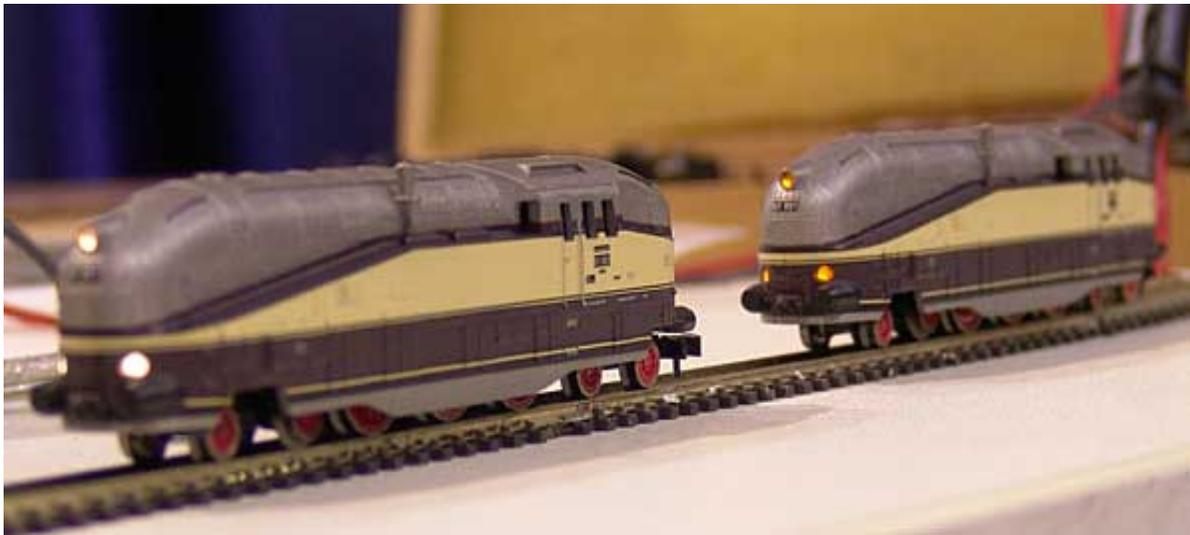
Achim Grob, Hightech-Modellbahnen, zeigte verschiedene Beleuchtungseinsätze, die ab geringer Spannung gleichmässige Helligkeit ermöglichen. Auch die Lichtfarbe ist deutlich angenehmer, wie das vordere Modell im Vergleich zur Serie zeigt.
