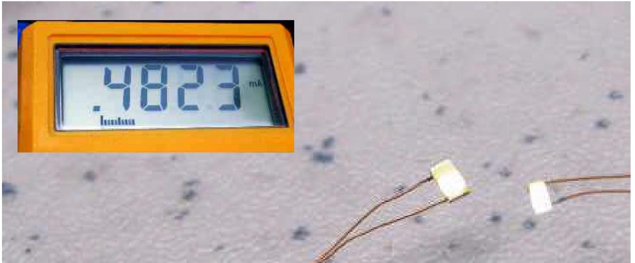
Bild 5: Kaum zu glauben, die Helligkeit von beiden LEDs ist gleich und wird mit lediglich 0,5 mA (!!!) erzeugt.
